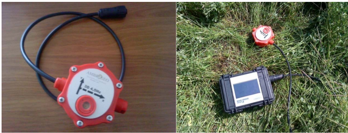
da sx a dx sensore del tromografo Echo 3 e configurazione completa sul campo
