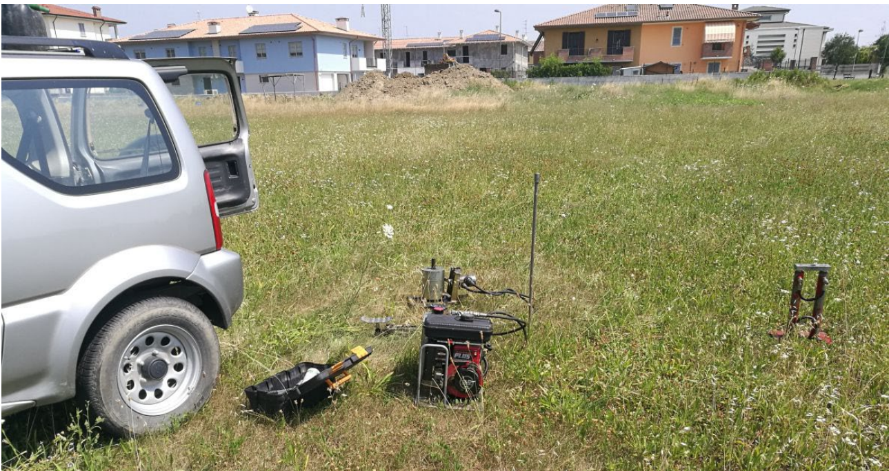
Fasi esecutive della prova penetrometrica P1
